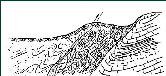
图 逆断层为主的断层破碎带示意图
