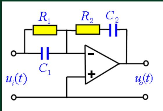
**PID具有PD和PI双重作用，能全面地提高系统控制性能。其作用相应于滞后—超前校正。**
