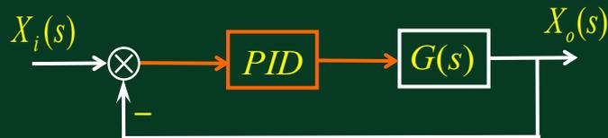
PID控制器是实际工业控制过程中应用最广泛、最成功的一种控制方法。主要特点：
