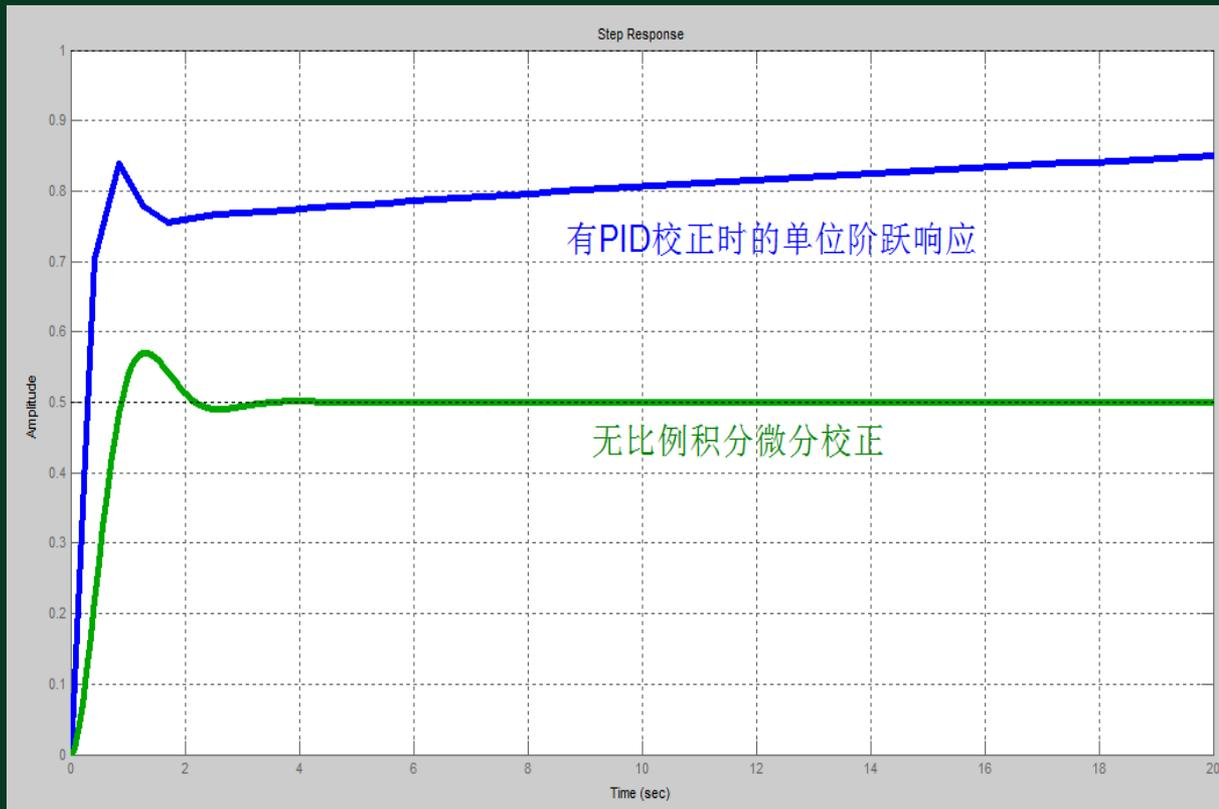
**PID提高系统稳态精度并改善系统的动态性能。**
