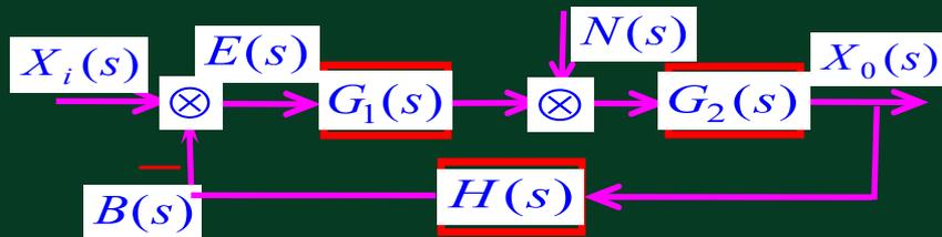
反馈控制系统的典型结构
