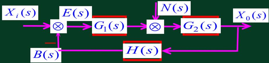
反馈控制系统的典型结构
