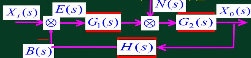
反馈控制系统的典型结构
