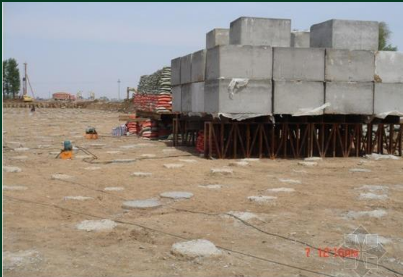
图 9 CFG 桩复合地基净载试验
