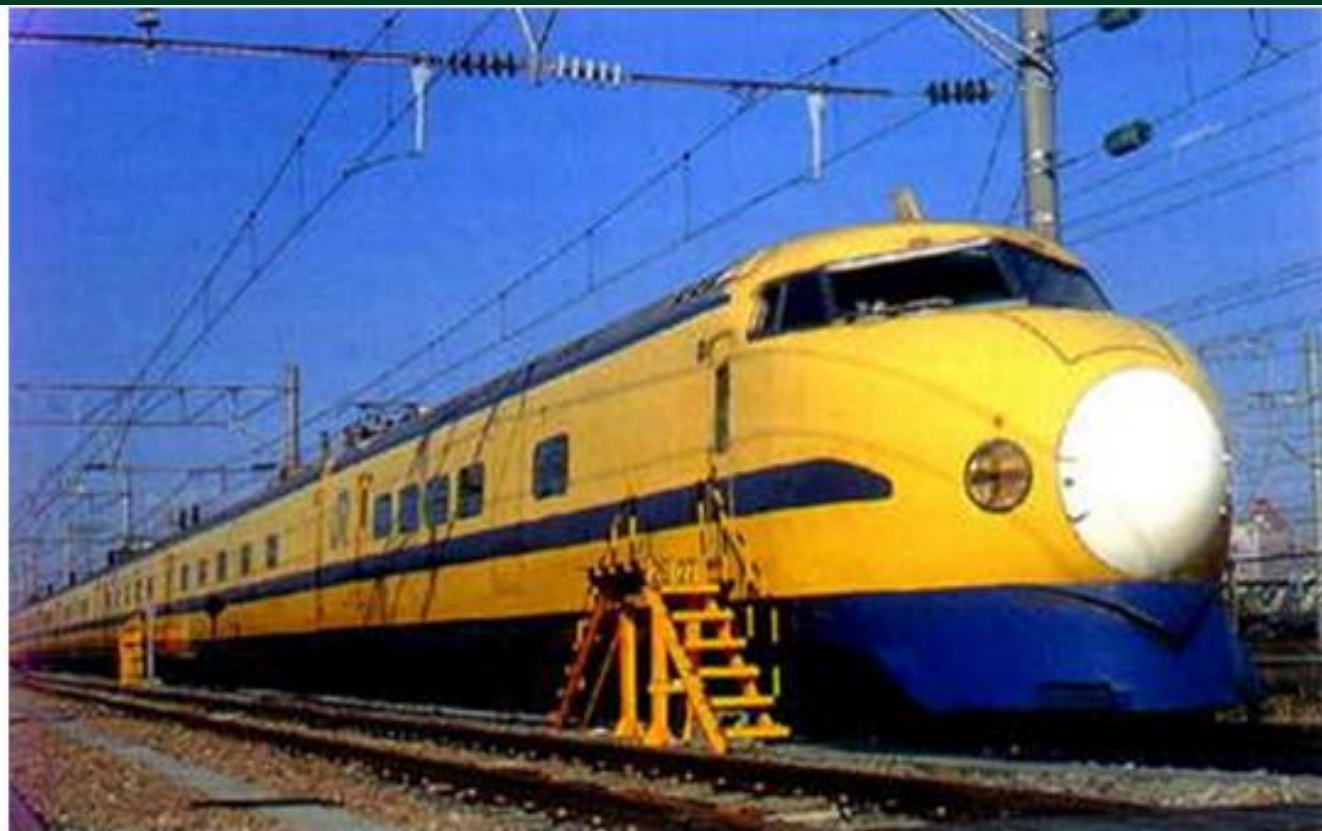
高速铁路线路监测诊断系统
