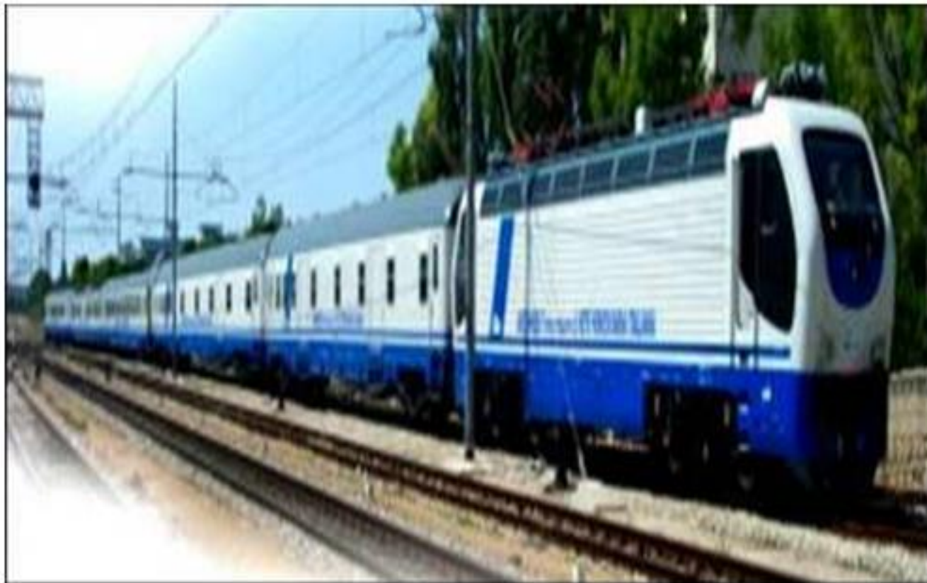
意大利“阿基米德”综合检测列车
