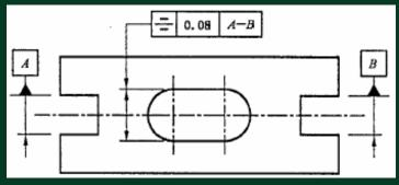
公差带为间距等于公差值**t**、 对称于基准中心平面的两 平行平面之间的区域。 提取(实际)中心面应限定在间距等于0.08、对称于公共基准中心平面*A-B*的两平行平面之间。
