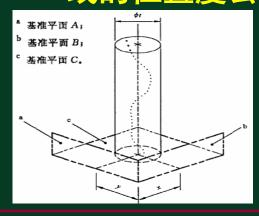
公差值前加注**D**,公差带为 直径等于公差值**t**的<mark>圆柱面</mark>所 限定的区域。该圆柱面的轴 线的位置由基准平面**C、A**、 **B**和理论正确尺寸确定。
