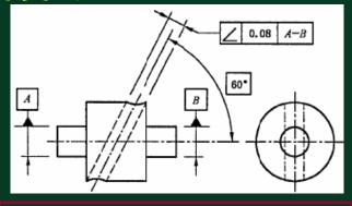
提取(实际)中心线应限定在间距等于公差值0.08的两平行平面之间。该两平行平面按理论正确角度60°倾斜于公共基准4-B。
