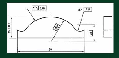
公差带为直径等于公差值 t、圆心位于具有理论正 确几何形状上的一系列圆 的两包络线所限定的区域 提取(实际)轮廓线应限定在直 径等于公差值0.04、圆心位于 被测要素理论正确几何形状上 的一系列圆的两包络线之间。
