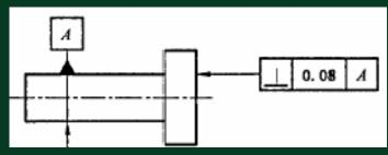
公差带为间距等于 公差值t且垂直于基 准轴线的两平行平 面所限定的区域。 提取(实际)表面应限定在 间距等于公差值0.08的两 平行平面之间。该两平行 平面垂直于基准轴线A。
