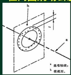
公差带为在任一垂直于基准 轴线的横截面内、半径差等 于公差值*t*、圆心在基准轴线 上的两同心圆所限定的区域。
