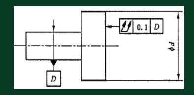
公差带为间距等于公差值 t、垂直于基准轴线的两 平行平面所限定的区域。 提取(实际)表面应限定在 间距等于0.1、垂直于基准 轴线**D**的两平行平面之间。
