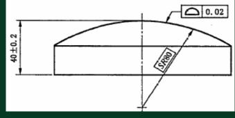
公差带为直径等于公差值t、球心位于被测要素理论正确形状上的一系列圆球的两包络面所限定的区域。
