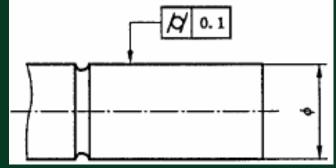
公差带为半径差等于 公差值t的两同轴圆柱 面所限定的区域。 提取(实际)圆柱面应限 定在半径差等于公差值 0.1的两同轴圆柱面之间。
