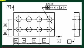
各提取(实际)中心线应各自限定在直径等于公差值0.1的圆柱面内。该圆柱面的轴线应处于由基准平面C、A、B和理论正确尺寸20、15、30确定的各孔轴线的理论正确位置上。
