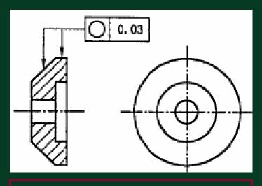
在圆柱面和圆锥面的任意正横截面内,提取(实际)圆周 应限定在半径差为公差值 0.03的两共面同心圆之间。
