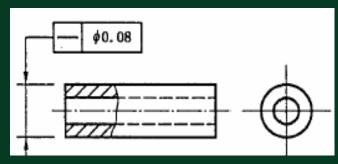
外圆柱面的提取(实际)中 心线线应限定在直径等于 公差值 **Ф** 0.08的圆柱面内。
