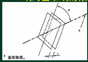
公差带为间距等于公差值*t* 的两平行平面所限定的区域。该两平行平面按给定 角度倾斜于基准轴线。
