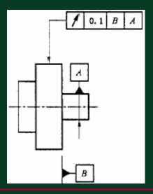
在任一平行于基准平面B、垂直于基准轴线A的截面上,提取(实际)圆应限定在半径差等于0.1、圆心在基准轴线A上的两同心圆之间。
