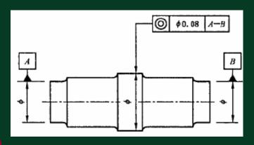
公差值前加注 $\phi$ ,公差带为直 径等于公差值t的圆柱面所限 定的区域。该圆柱面的轴线与 基准轴线重合。
