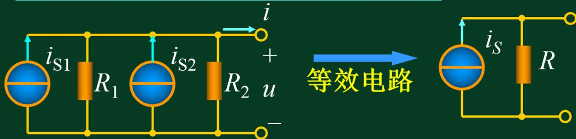
$$i = i_{s1} - u/R_1 + i_{s2} - u/R_2 = i_{s1} + i_{s2} - (1/R_1 + 1/R_2)u = i_s - u/R$$
