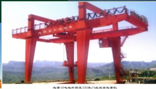
高臂10吨电液平衡100米门式双梁桥式起重机
