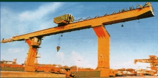
L型5~50/10吨吊钩门式起重机
