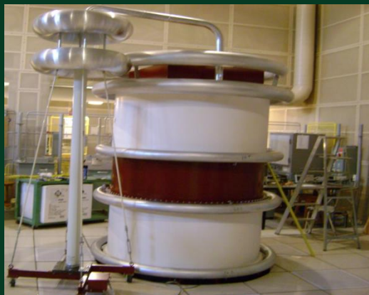
500kV AC 高压发生器
