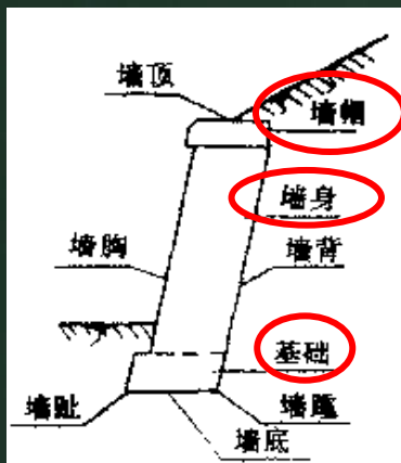
重力式挡土墙构造
