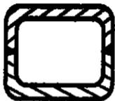
(c) 用两块钢板弯曲后焊成
