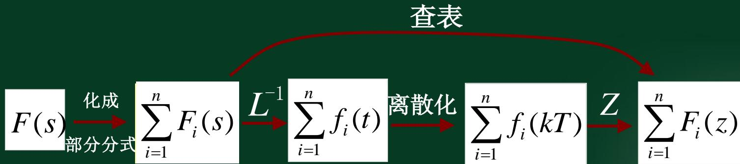
$$\sum_{i=1}^n \frac{A_i}{s - s_i} \rightarrow \sum_{i=1}^n A_i e^{s_i t} \rightarrow \sum_{i=1}^n \frac{A_i z}{z - e^{s_i T}}$$
