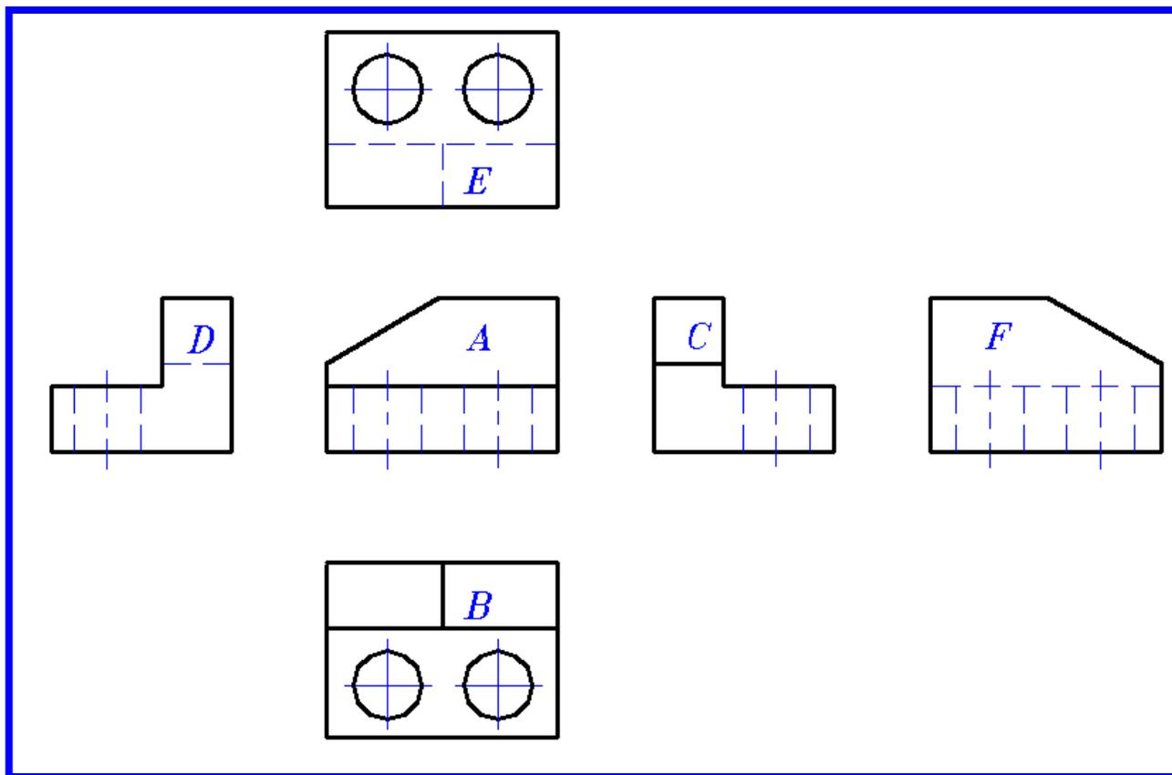
在建筑工程中，各视图可按专业需要进行配置。但应在各视图下方注出图名，并在图名下画一粗实线。
