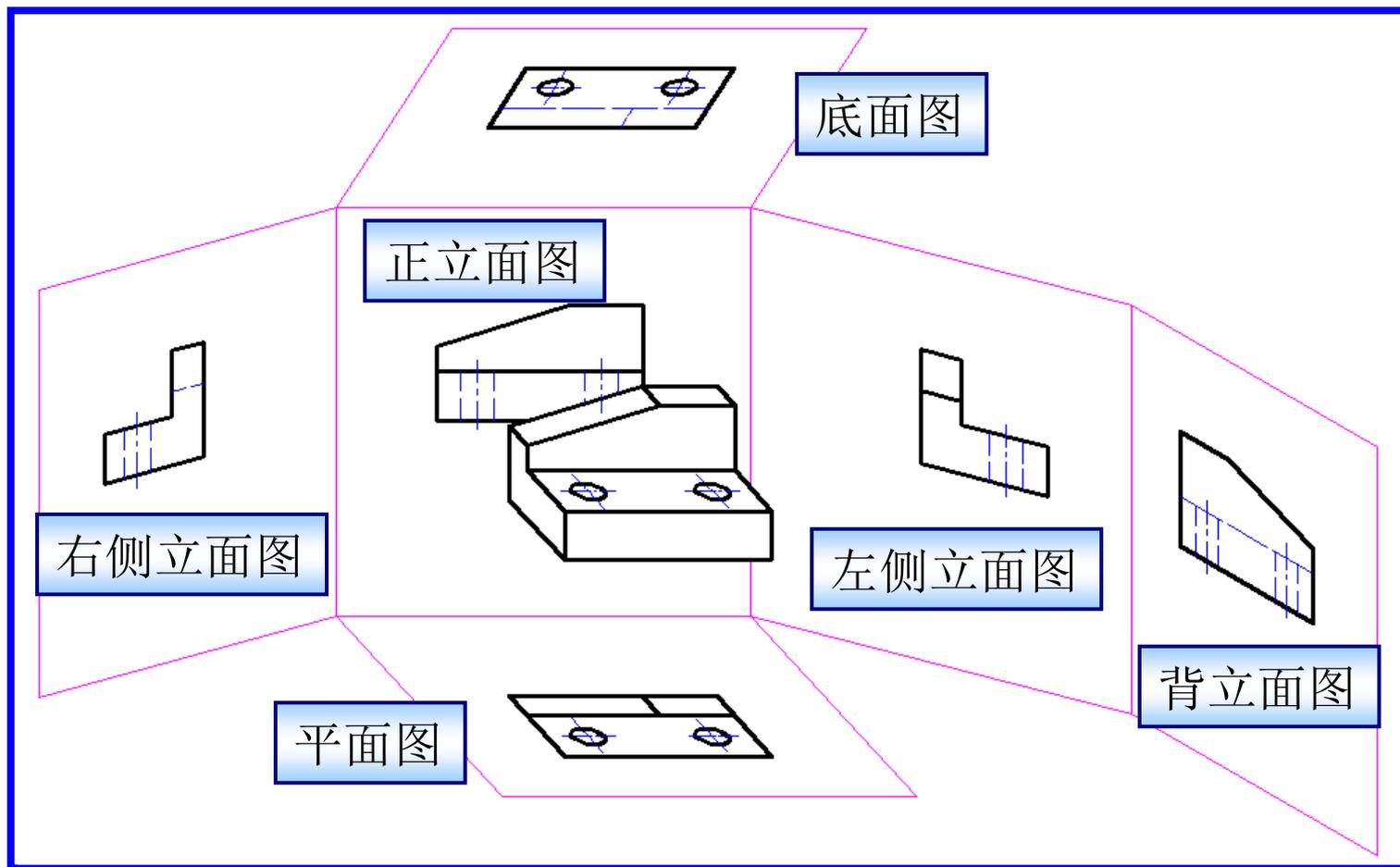
正立面图被确定之后，其他基本视图与正立面图的配置关系也随之确定，此时，可不标注视图名称。
