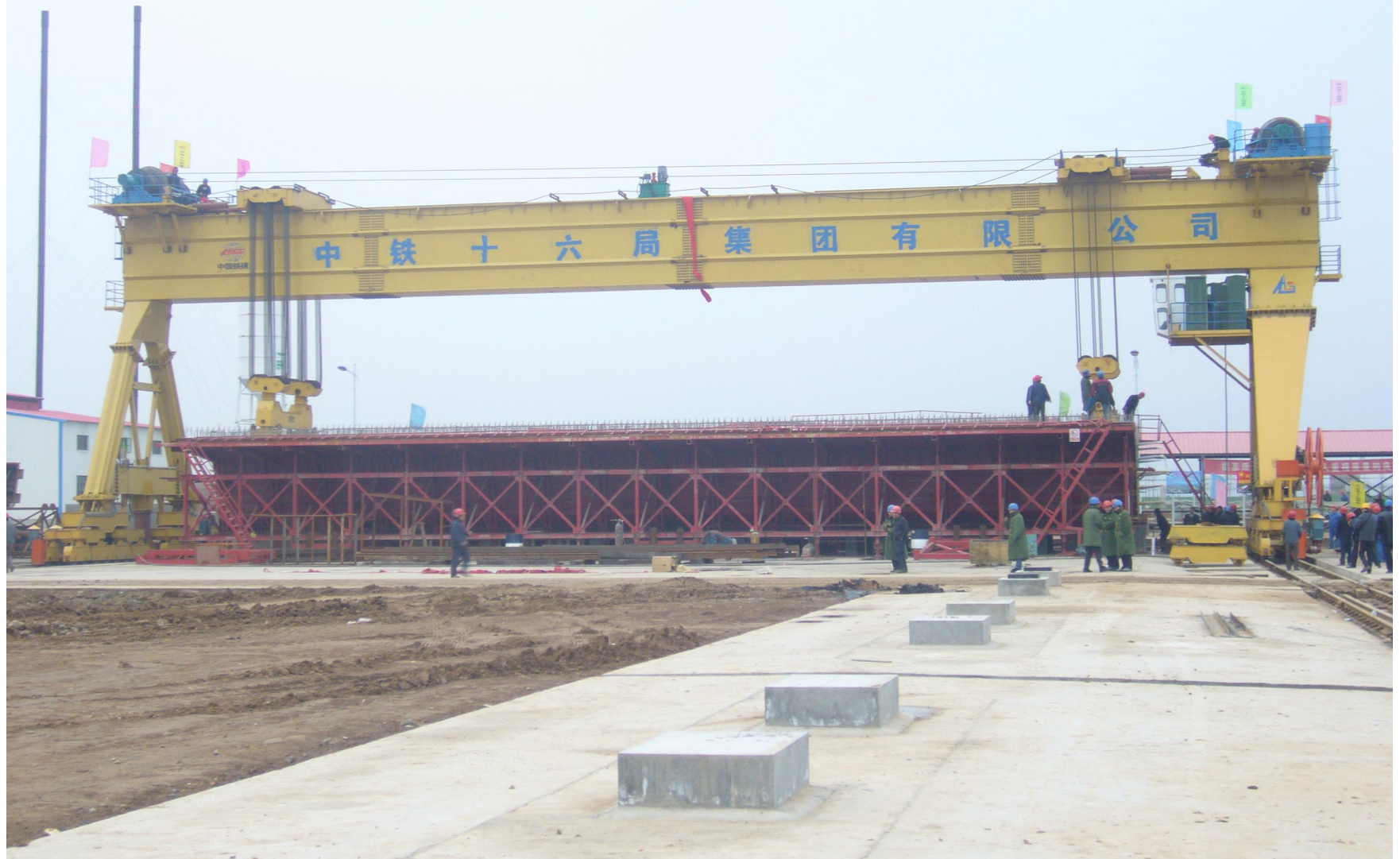
客专预应力混凝土简支箱梁起重机
