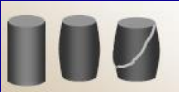
铸铁压缩断口
